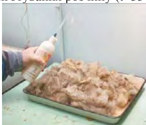
в) зволоження зразка вовни (до W_i )
