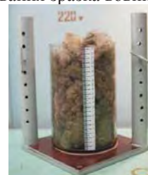
д) завантаження зразка в циліндр
