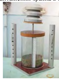
ж) встановлення вантажу ( G_i )
