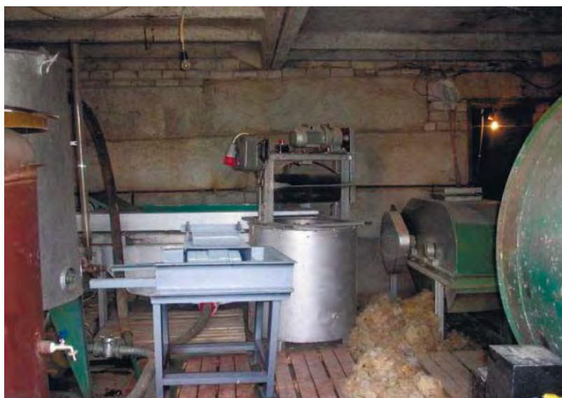
Рисунок 5 – Малогабаритна плитно-валяльна машина ПВМ-1 у складі технологічного модуля ТМ ПОВ-8,0
