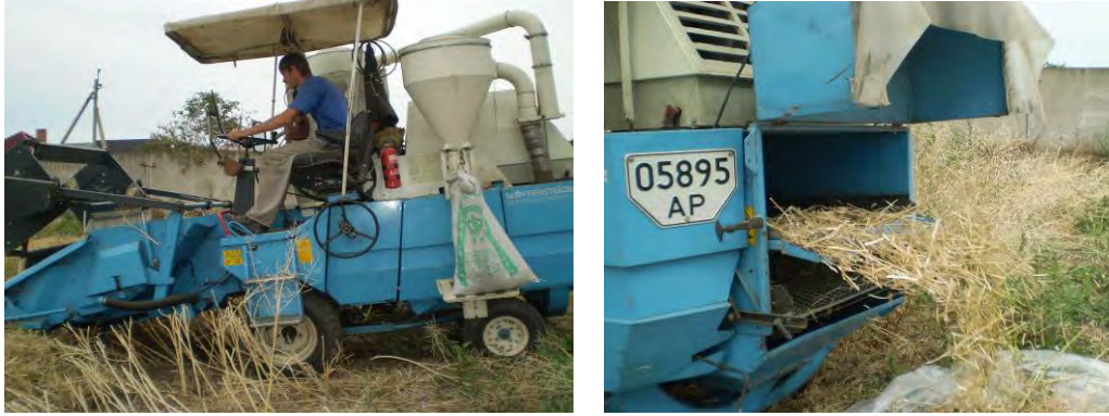
Рис. 3. Дослідження по визначенню якості роботи молотильного апарату комбайна при збиранні врожаю ріпака
