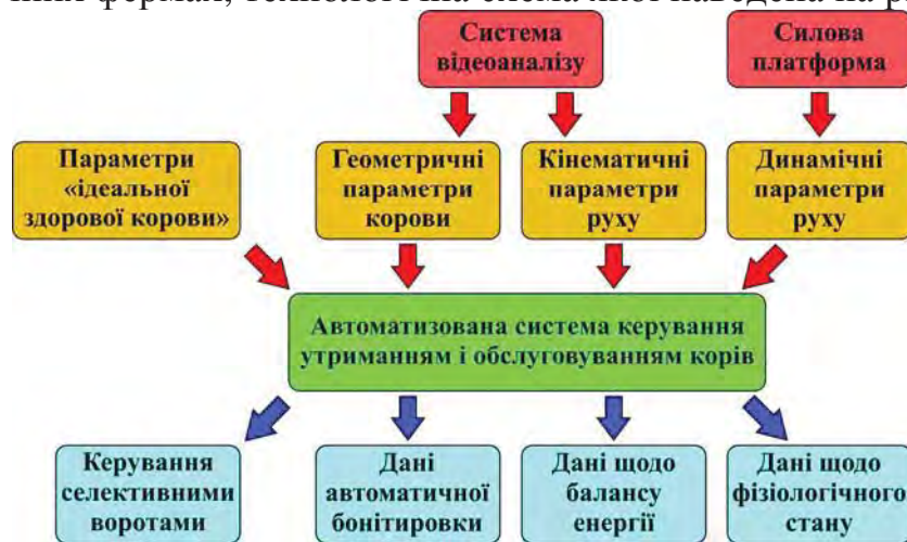
Рис. 3. Технологічна схема автоматизованої системи керування утриманням і обслуговуванням корів
