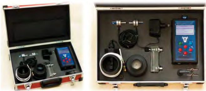
Рис. 4 – Комплект устаткування контролю вакуумметричних параметрів молочно-доїльного обладнання (розробка ІМТ НААН)
