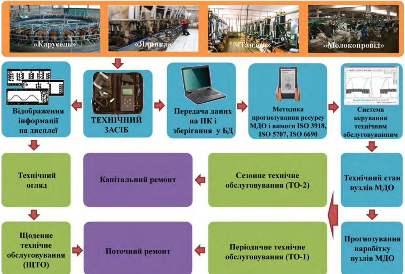
Рис. 3 – Стратегія техніко-технологічного моніторингу молочно-доїльного обладнання
