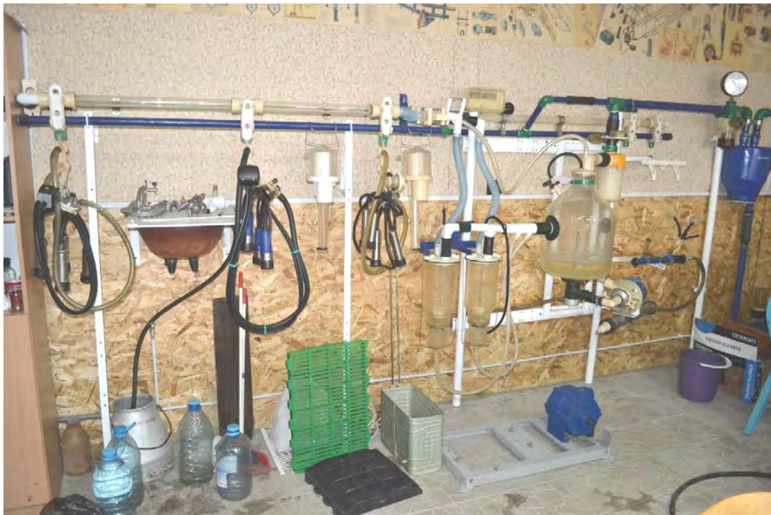
Рис. 1. Загальний вигляд експериментального стенду лінійної доїльної установки типу УДМ з верхнім молокопроводом
