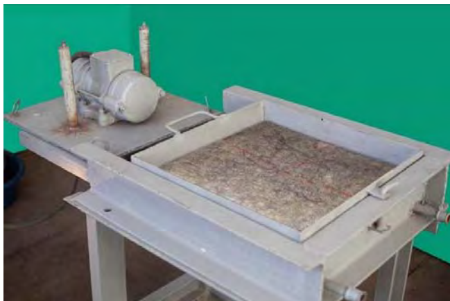
Рисунок 5 – Робочий процес ущільнення та формування повстяного пласта плитно-валяльною машиною ПВМ-1
